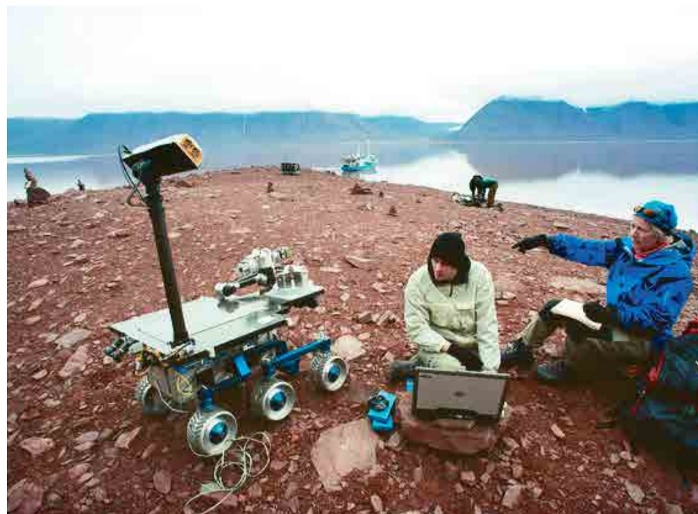
Аппарат Athena, предназначенный для испытания систем управления и оборудования марсоходов. Архипелаг Шпицберген, проект AMASE, 2009 г.
