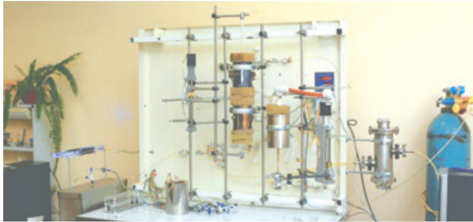
Оборудование для подготовки проб для радиоуглеродного анализа на ускорительном масс-спектрометре
