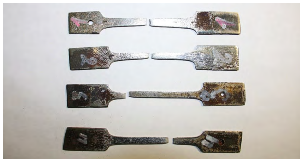
Образцы, испытанные на одноосное растяжение, выплавленные из железной руды, добытой в рудопроявлении Кэнтик Верхневилуйского района
