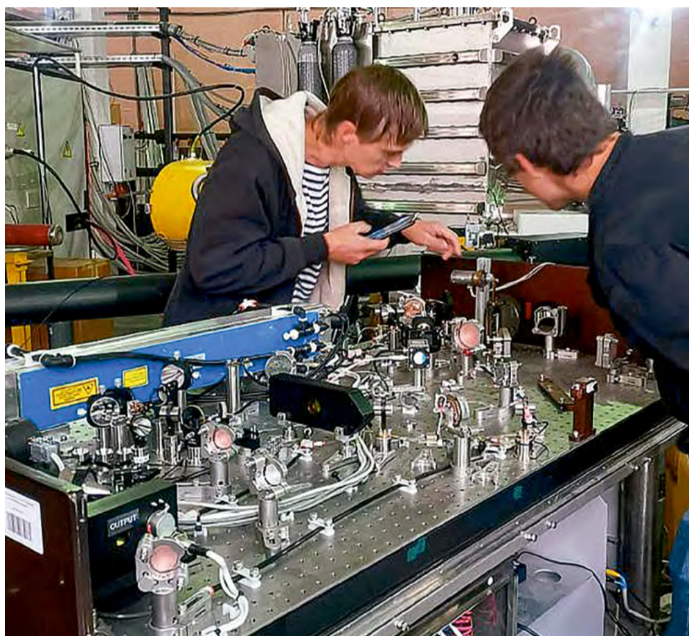
Процесс настройки дисперсионного интерферометра для токамака «Глобус-М2»
