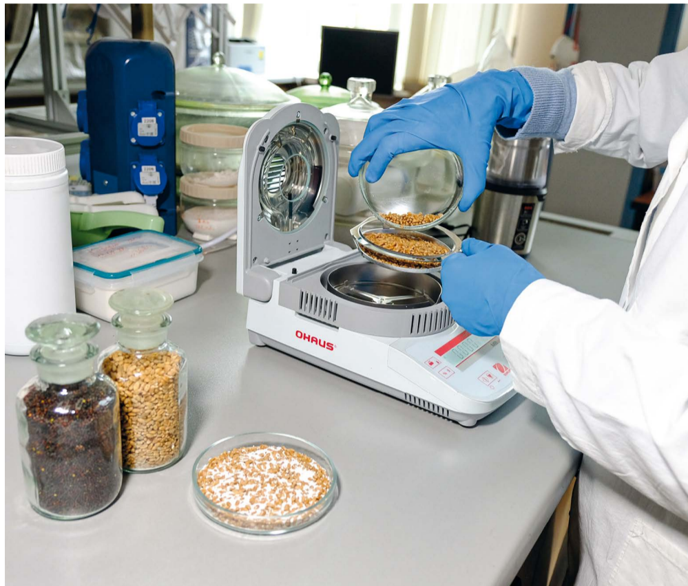
Определение влажности пшеницы методом воздушно-тепловой сушки
