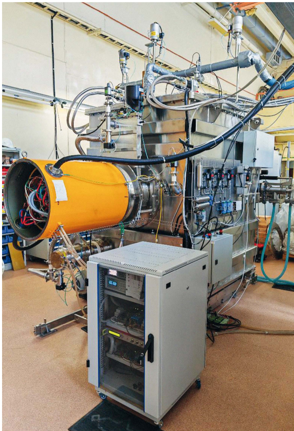
Инжектор мощных атомарных пучков, разработанный и произведенный в ИЯФ СО РАН
