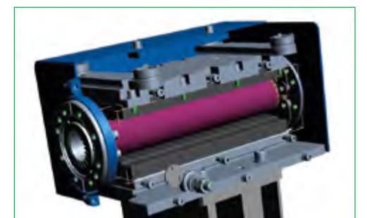
Кикер инжекции в основное накопительное кольцо. Пурпурным показана керамическая вакуумная камера (реально она кремового цвета). Вокруг ферритовый сердечник
