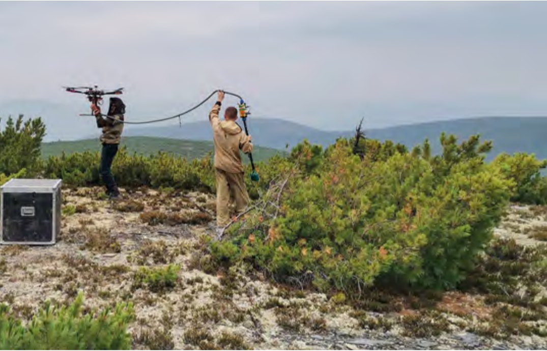
Процесс проведения геофизической съемки с помощью БПЛА
