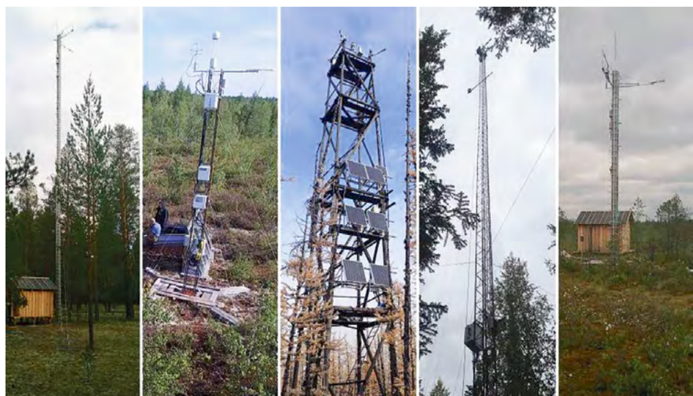
Станции с микрометеорологическим и газоаналитическим оборудованием сети Krasflux
